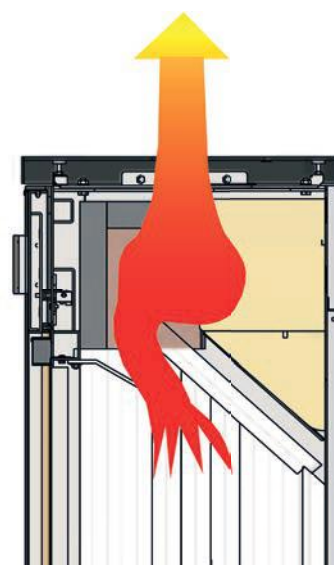
Principe de l'accumulation de la chaleur
