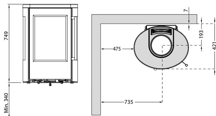
Le TT23RGW est conçu pour une installation sur un mur ininflammable. Si le revêtement de sol est inflammable, le poêle doit être posé à 340 mm minimum du sol. Pour une solution de montage optimale et sécuritaire, veuillez consulter votre revendeur-installateur agréé.
